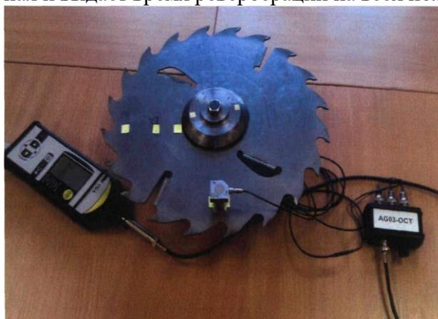
Рис. 1 Экспериментальная установка
